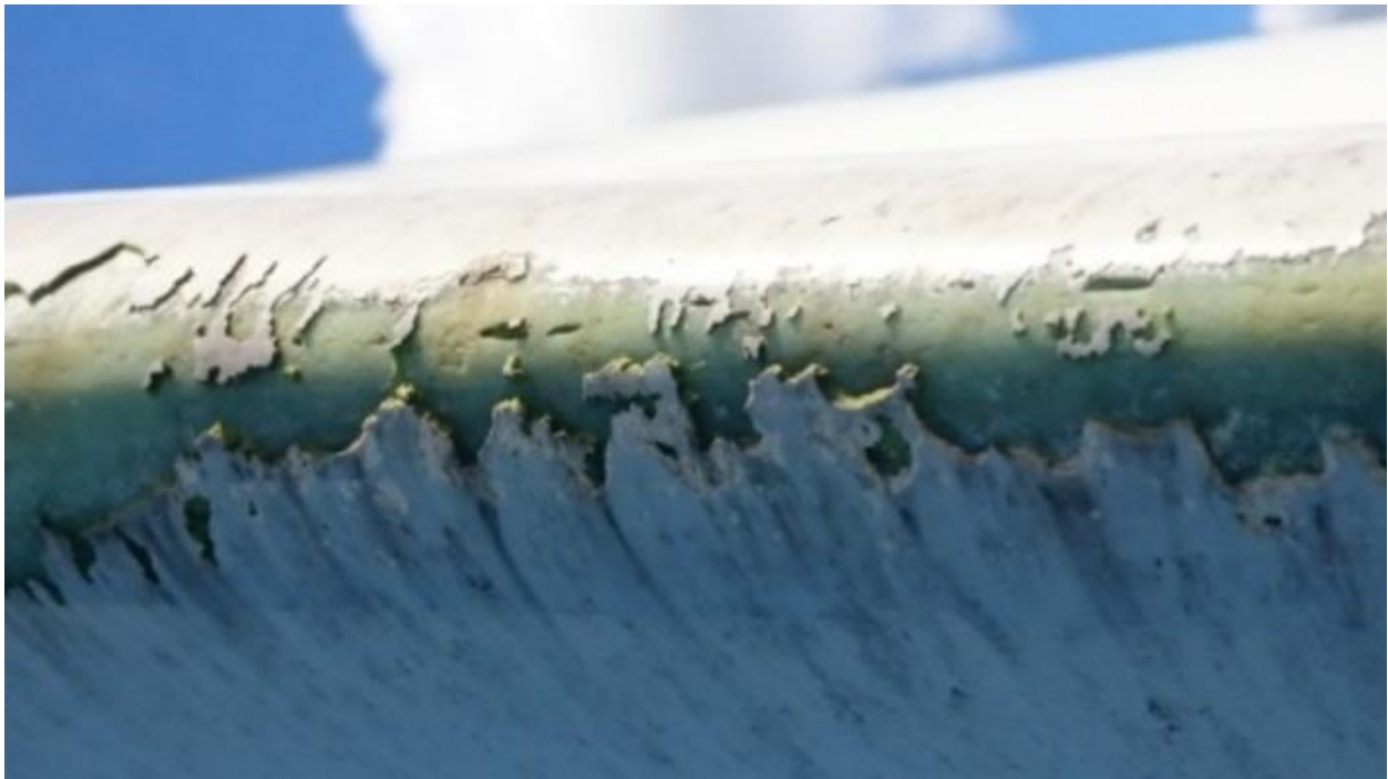
Voorbeeld van erosie aan een rotorblad
